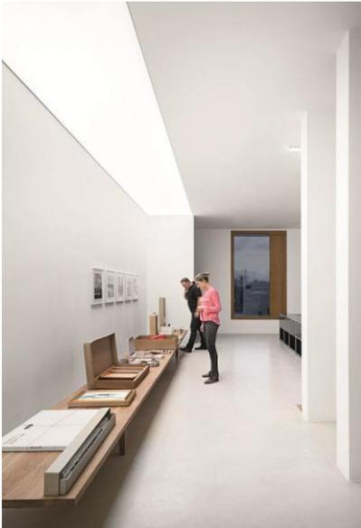
**Bild 3 :** L'élément central du bâtiment est un plafond lumineux à LED avec commande qui s'étire à travers le nouveau bâtiment.
