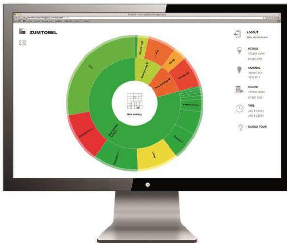
**Fig. 2 :** Avec la représentation explicite dans le diagramme Sun-Burst, il est même possible de commander et d'optimiser la consommation énergétique de bâtiments, d'étages, de pièces et même de postes de travail individuels
