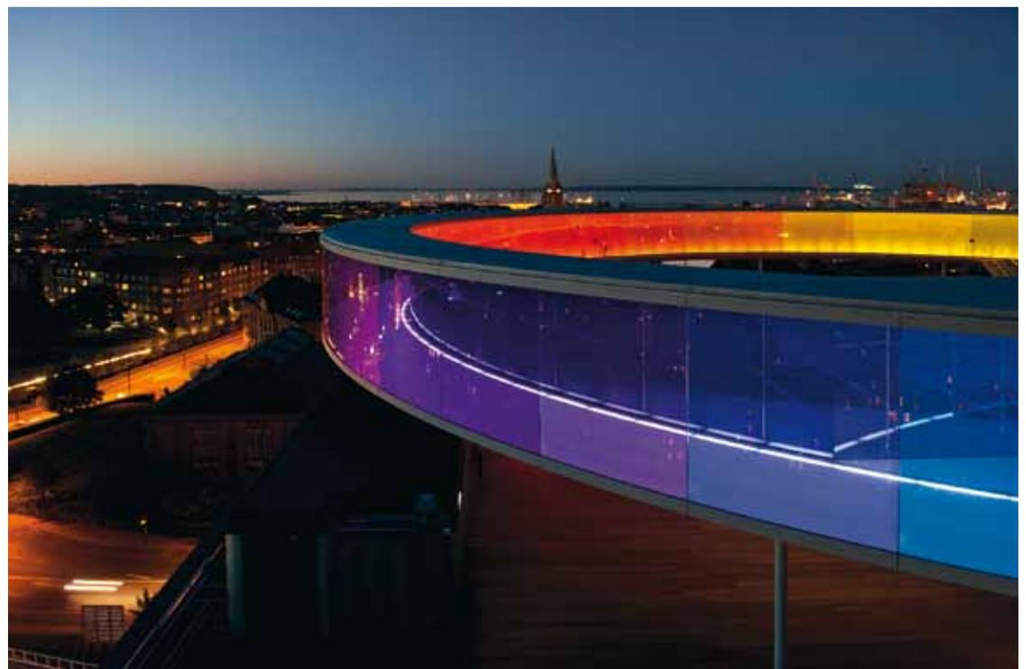
B2 | Des luminaires spéciaux insérés dans le sol illuminent l'extraordinaire installation dans les couleurs spectrales – comme un vrai arc-en-ciel. Pour obtenir cet effet, le plafond est éclairé de manière symétrique de sorte que les panneaux de verre colorés soient éclairés de l'intérieur.
