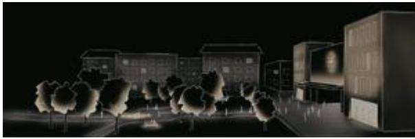
**Bild 1a:** Spätere Abendstunden: Sanftes Licht entlang der Verkehrswege gibt Orientierung und Sicherheit. Vertikal beleuchtete Bäume verbessern die räumliche Wahrnehmung. Dank einer gut ausgeleuchteten Fassade ist der Bahnhof von überall als solcher zu erkennen. Weitere, sanft akzentuierte Gebäude komplettieren das nächtliche Stadtbild.
