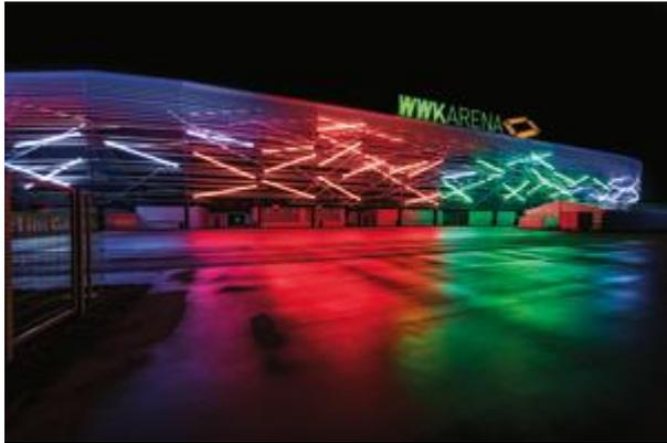
**Bild 3:** Zumtobel entwarf spezielle Leuchtröhren, die dieselbe Dimension wie die Aluminiumrohre der Fassade haben und Teil der extravaganen Fassadenkonstruktion sind.
