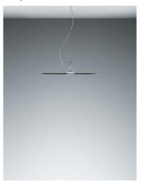
**Bild 2:** Die Pendelleuchte verfügt über eine Side-lit-Technologie: Bei dieser wird das LED-Licht der Lichtquellen in der transparenten Lichtleiterplatte ausgekoppelt und gleichmäßig von der Mitte zum Rand verteilt.
