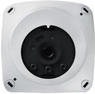
**Bild 5:** Der Kontrastsensor ATIVO integriert vorhandenes Tageslicht, hält den definierten Lichtlevel konstant und detektiert sich bewegende Objekte. Die größte Stärke liegt in der freien Gestaltung von rechtwinkligen Erfassungszonen, bis zu fünf pro Sensor.
