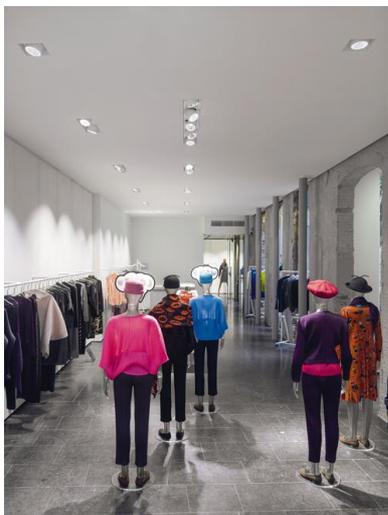
**Image 3 :** Chaque mannequin reçoit l'éclairage d'un projecteur d'accentuation avec caractéristique Spot et d'un autre avec caractéristique Flood du système [INTRO](#), insérés au ras du plafond.
