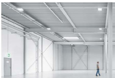
Les armatures intérieures à LED montées sur des rails porteurs TECTON peuvent au besoin être repositionnées sans problème.
