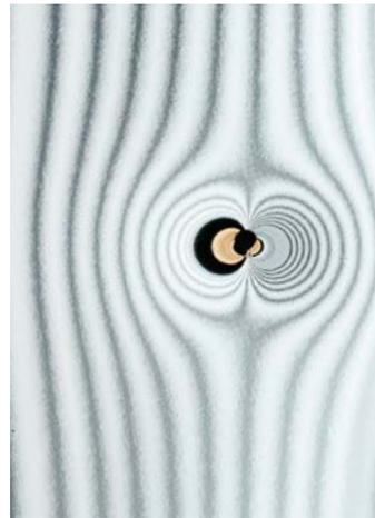
Détection des défauts avec COESA – Contrôle qualité **non réussi**
