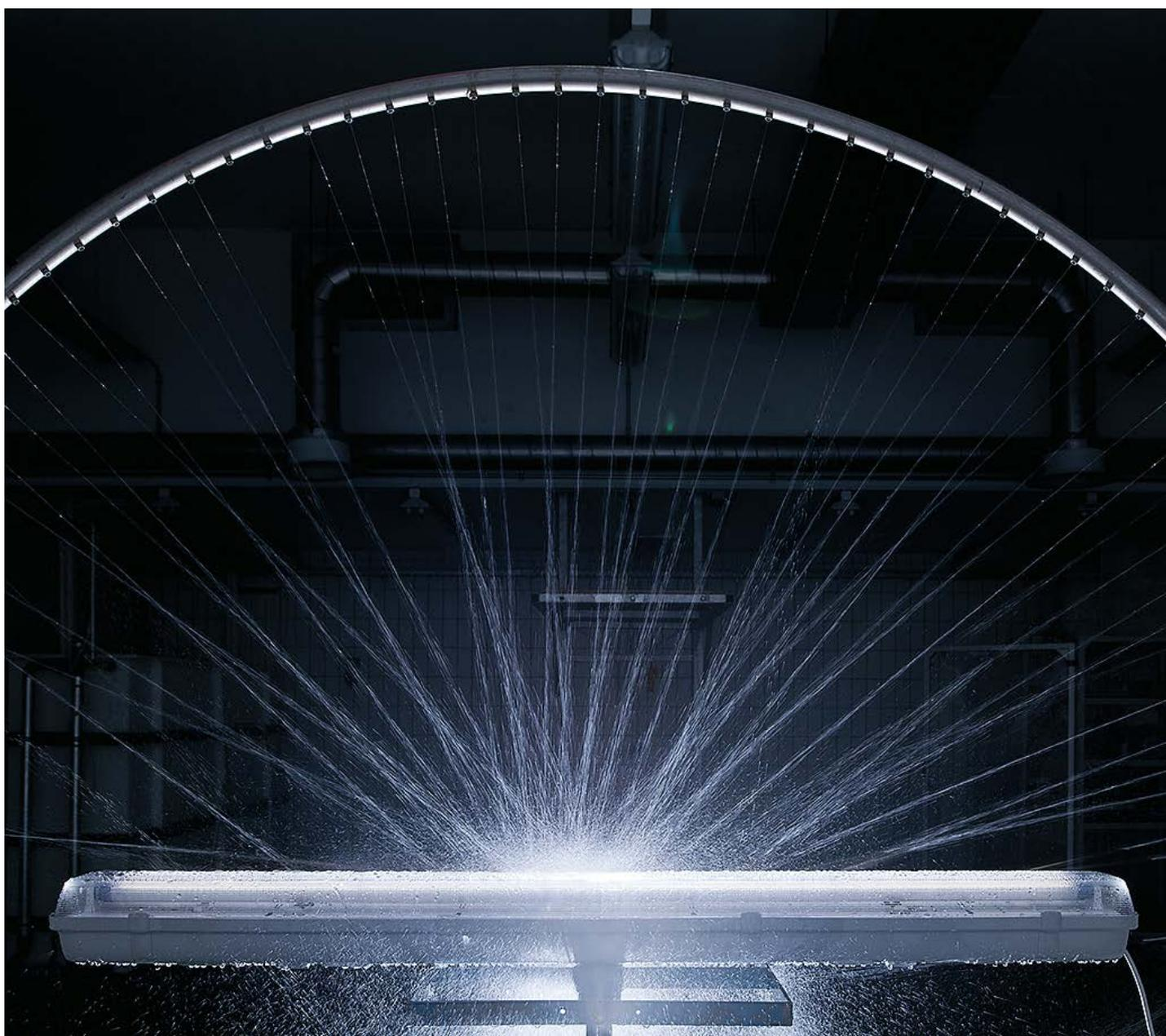
Um die Zuverlässigkeit der Zumtobel Leuchten zu gewährleisten, wird deren Wasserdichte unter extremen Bedingungen getestet.
