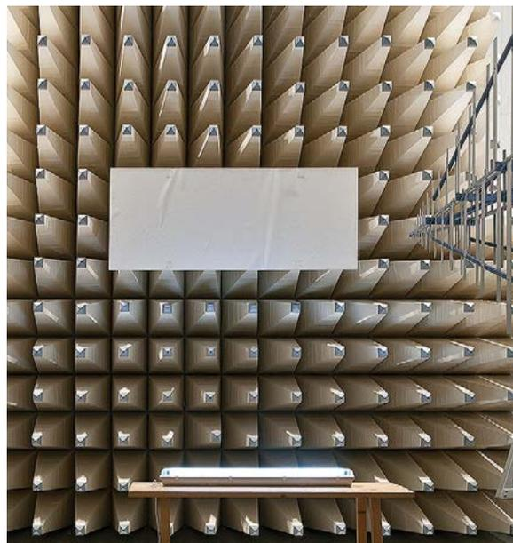
Gründliche EMV-Prüfungen im Zumtobel Labor stellen einen optimalen Schutz vor Elektrostatischen Entladungen, Spannungsspitzen und Stoßspannungen sicher.
