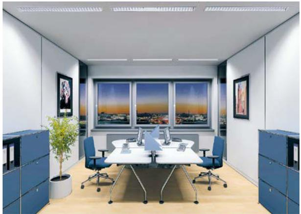
Raumbezogene Beleuchtungskonzepte berücksichtigen weder einzelne Arbeitsbereiche noch unterschiedliche Sehaufgaben. Sie orientieren sich an der anspruchsvollsten Aufgabe im Raum. Die Position des Arbeitsplatzes ist nicht definiert, der ganze Raum verfügt über eine gleichmäßige Lichtqualität.
